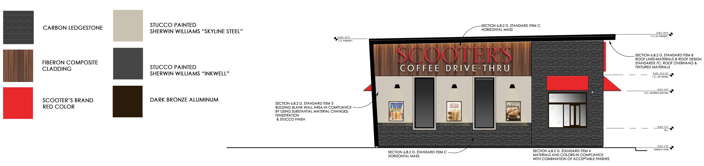
4 DRIVE THRU SIDE EXTERIOR ELEVATION
